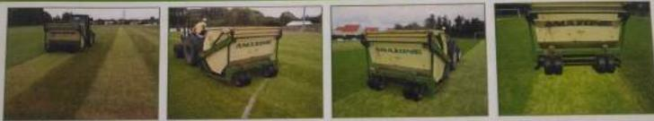
La défeutreuse (ou régénérateur) pénètre dans le sol à quelques millimètres de profondeur et ses lames verticales extirpent le feutre composé de racines, et de feuilles mortes. Cette opération permet de limiter le feutre et la mousse et d'améliorer la planimétrie.
