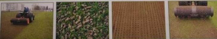
Réalisation de perforations dans la couche superficielle du sol avec extraction et émiettement des carottes. L'appareil muni de louchets, effectue 300 trous une profondeur de 10 à 14 cm.
